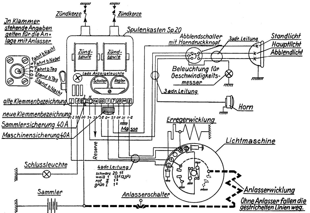
Schaltbild SB 500 mit Spulenkasten Sp 20
