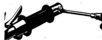
11 V Halteschraube am Drehgriff herausdrehen
