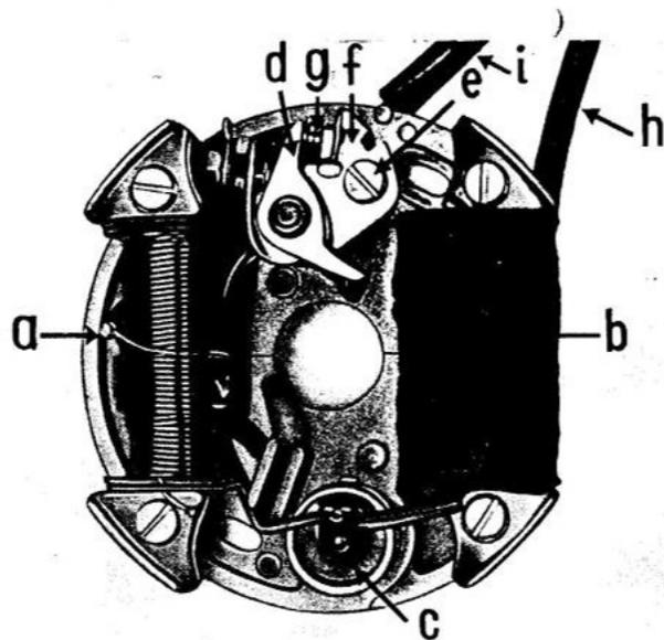
Abb. 62 Aufbau der Grundplatte des Schwung-Lichtmagnetzünders
