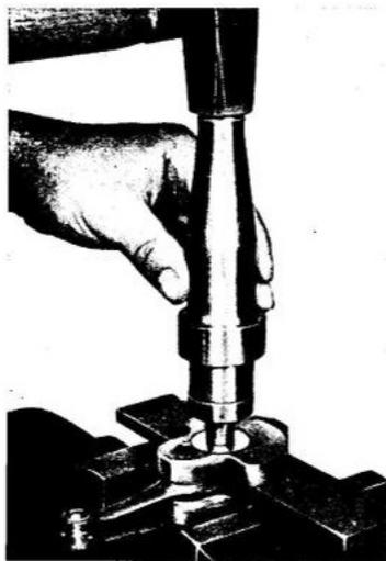
Abb. 43 Rillennlager auf den Kurbelwellenzapfen aufziehen VI / 57 / 813
