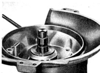
32 M Gewindeinsatz und Gleithülse bei aufgeschobener Lichtmaschinengehäusehälfte
