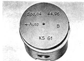
46 M Kennzeichnung auf Kolbenboden VI / 55 / 877
