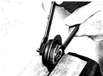
57 M Zerlegen bzw. Einstellen des Ausrücklagers kpl. 0301-13150-05 (ab Motor-Nr. 03 042 312) VI/57/544
