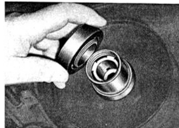
52 M Ausgebautes Ausrücklager VI/54/4927
