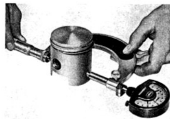
44 M Kolben mit Mikrometer nachmessen VI / 57 / 737
