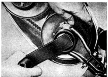
51 M Ausrücklager ausbauen VI/55/880
