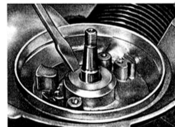
37 M Radialdichtung auf Schwungradmagnetläuferseite ersetzen
