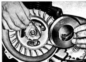
10 E Einbau der Gummidichtung (0301-38122-00) VI/56/102
