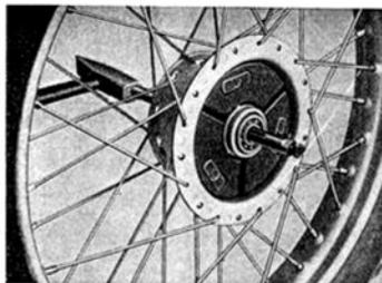
5 H Hinterradnaben-Lagerausbau
