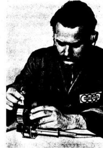
29 E Anker auf Spulenschluß prüfen (Abhordgerät)
