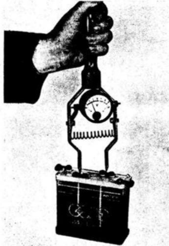
48 E Batterie mit Zellenprüfer für Motorradbatterien prüfen
