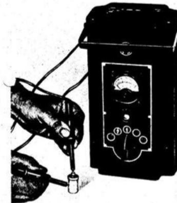
19 E Kondensator mit Philips-Prüfgerät prüfen
