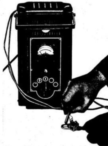
18 E Unterbrecher auf Massenschluß prüfen
