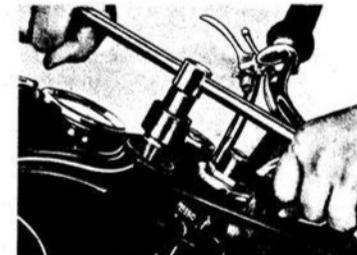
10 V Ringmutter vom Gleitrohr abschrauben
