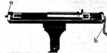
40 V Dämpferkopf aus der äußeren Schutzhülse entfernen
