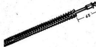
8 V Hauptfeder der RT 250 S mit Dämpfer
