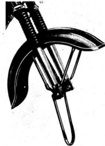
29 V Vorderradkofflügel mit abklappbarem Stützbugel
