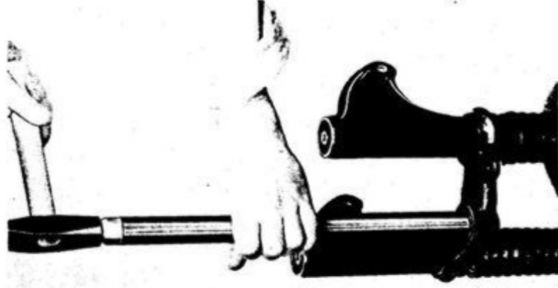
12 R Gabellaufring mit Treibhülse aufschlagen
